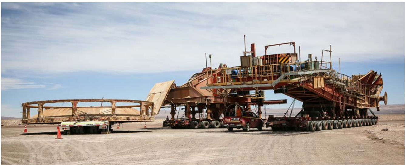
Traslado de Rotopala HR 7100, maquinaria que tiene 40 metros de largo, 18 metros de alto, y un disco de 12 metros de diámetro.
